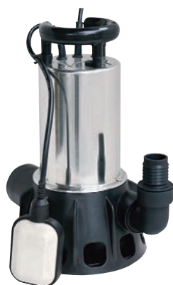
BOMBA SUBMERGIBLE AIGÜES BRUTES 9640862 Motor elèctric, 230V, 1100W, cabal màx: 20000l/h, aspiració màx.: 10m, immersió màx a nivell de l'aigua: 7m, cos de bomba: Inox. Diàmetre pas sòlids: 38mm, IP X8, 10m de cable, interruptor de nivell.
