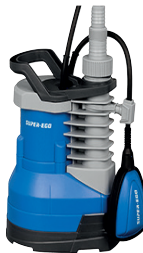
BOMBA SUBMERGIBLE AIGÜES NETES 9685471 Cabal màx 9.000 L/h. 400W. Alçada elevació màx 8m. Profunditat immersió màx 7 m. Partícules màx 5 mm.
