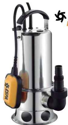
BOMBA SUBMERGIBLE AIGÜES BRUTES 9676312 Motor elèctric. 1100 W, diàmetre màx. de sòlids: 35 mm. Alçada màxima: 7 m. immersió Cabal màxim: 18.000 litres/h. Material: Inox. Alçada màxima 8 m.
