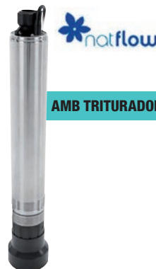
BOMBA PER A FOSSES SEPTIQUES AMB TRITURADOR 9694515 Potència 1.600 w. Cabal màx 18.000l/h alçada màx. 15m. Densitat màx del fluid 1,2gr/cm³. Cable elèctric 10 m. Alçada mín. succió 8cm. En cos de fosa i motor en acer inox.
