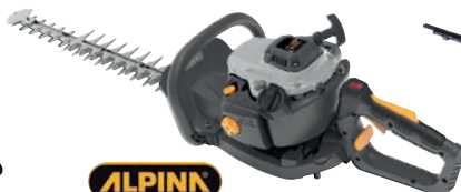
TALLABARDERS A GASOLINA ALPINA 9704381 Potència 0,65 kW, sistema antivibració en ressorts múltiples, fulla doble acció de 700 mm amb protector metàl·lic 56 cm de tall, manillar giratori de 180°, amplada de tall 27 mm, velocitat de fulla 3000 spm. 4,95 kg.
