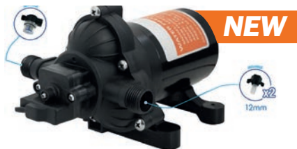
BOMBA DE PRESSIÓ AUTOMÀTICA 9708652 Ideal per a llocs on no es disposi de corrent 230V CA. Només aigua neta (filtre d'impureses inclòs) interruptor de pressió incorporat regulable. Alçada màx 31m. Cabal màx 700l/h. Consum 3,5A. Pot treballar en sec. autoaspirant. Sortida de 12mm. Ràcords i filtre inclosos.
