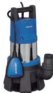
BOMBA SUBMERGIBLE AIGÜES BRUTES 9689967 Cabal màx.: 25.000 litres/hora. Potència: 1.300 W. Alçada d'elevació màxima: 11 metres. Profunditat d'immersió: 5 metres. Grandària màxima de partícules: 40 mm.
