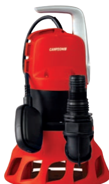
ELECTROBOMBA CAMPEON ITIP-1000 9685463 1000W. Ús continu. Drenatge potent aigües brutes (Ø màx 38mm pas sòlids). Cabal 19.200l/h. Alçada màx 11m R. 1"1/2H - ràcords 40/50mm. Profunditat màx immersió 7m. Maneta ergonòmica. Funcionament MAN o AUT.
